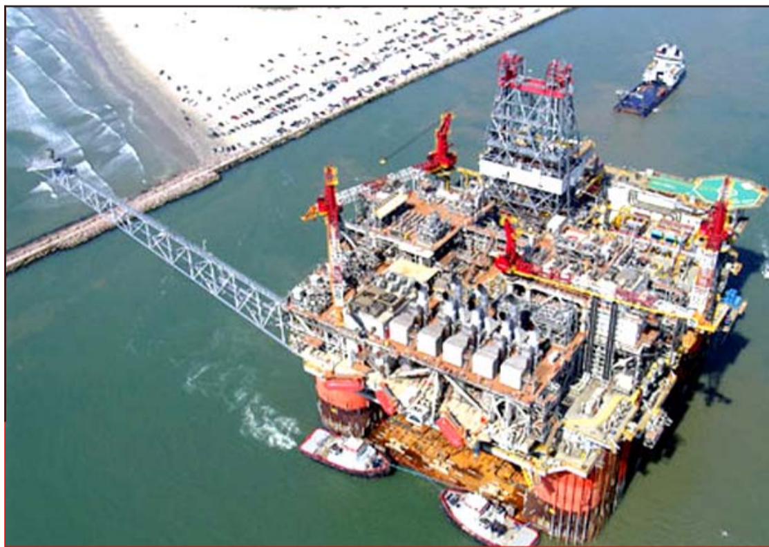
El Caballo de Trueno, instalada en el Golfo de México, es la plataforma semi-sumergible productora de petróleo y gas más grande de la compañía BP ■ Imagen tomada del sitio en Internet www.nickelinstitute.org
