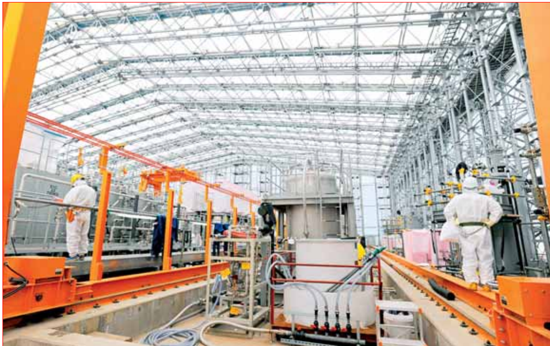
Máquina de filtrado de radiación conocida como Alpes, que se utiliza para limpiar el agua de fregado de la mayoría de los elementos radiactivos, incluidos el cesio y el estroncio, en la Compañía de Energía Eléctrica de Tokio, operadora de la planta de energía nuclear Fukushima Daiichi, en la prefectura de Fukushima, Japón ■ Foto Reuters
