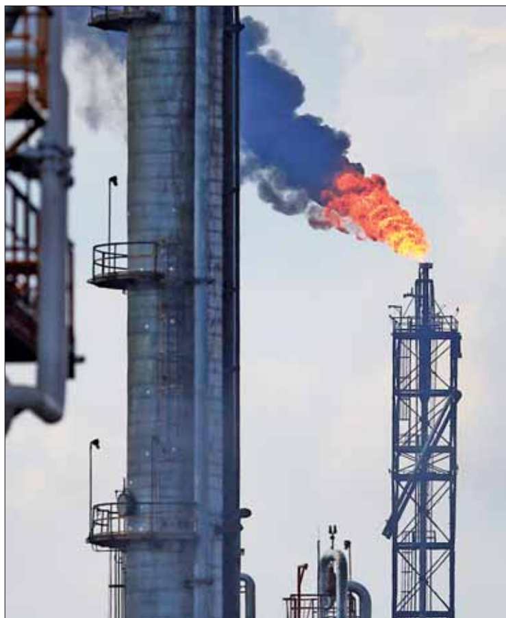
El exceso de gas es quemado y lanzado a la atmósfera en la refinería de Tula, Hidalgo ■ Foto Reuters
